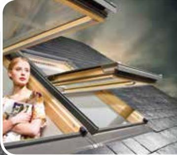
Les nouvelles fenêtres de toit **preSelect** peuvent s'ouvrir de deux façons : par rotation ou par projection. Elles sont équipées à cet effet d'un curseur latéral preSelect situé au centre du dormant (uniquement accessible lorsque l'ouvrant est ouvert). Les fenêtres ne peuvent donc être ouvertes chaque fois que d'une seule manière. Ce qui les rend plus stables et plus sûres.
