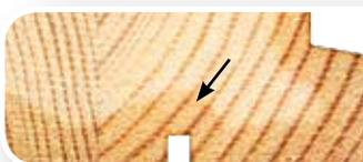
L'**imprégnation sous vide** par laquelle est traité le bois utilisé pour les fenêtres de toit FAKRO ainsi que la couche de vernis durable protègent les éléments en bois de la fenêtre. L'imprégnation sous vide est ici beaucoup plus efficace que l'imprégnation par trempage des éléments dans un produit d'imprégnation.
