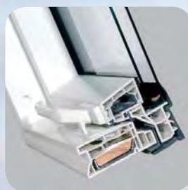
Les fenêtres les plus faciles à entretenir sont incontestablement les fenêtres en **PVC**. Les profilés extrudés à renforts métalliques, n'absorbent pas l'humidité, sont durables et sont résistants à la corrosion. Ces fenêtres sont destinées aux pièces d'eau avec un taux d'humidité constant et élevé. Les **fenêtres en PVC** sont classées dans la plus haute classe A, selon la norme NBN EN 12608, une norme de référence pour la fabrication de fenêtres en PVC.
