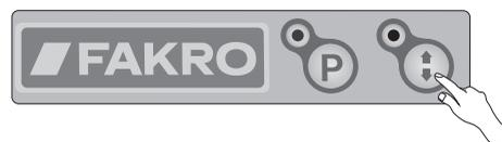
Afin de commander manuellement l'ensemble il faut presser la touche bouton de commande manuelle. Cette touche bouton fonctionne par séquences, par ex. le départ, l'arrêt, le départ dans l'autre sens, l'arrêt, etc.
