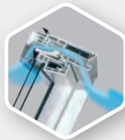
Entrée d'air réglable avec grille de ventilation, installée en partie haute dans le cadre dormant de la fenêtre. Ce système de ventilation offre en fonction de la largeur de la fenêtre un débit jusque 18 m<sup>3</sup>/h (à 2 Pa). Pour les locaux où une ventilation normale est exigée.
