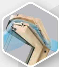
Entrée d'air réglable avec clapet de ventilation, installée en partie haute dans le cadre dormant de la fenêtre. Pour les locaux où une ventilation à grand débit est exigée. Le dispositif de ventilation V60P<sub>3</sub> est en outre auto-réglable (classe P3) et assure continuellement mais de manière contrôlée l'entrée d'air frais.
