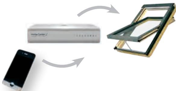
Le gateway est le "pont" entre le "world wide web" et tous les produits Z-Wave dans une maison. Par cette plate-forme, on a accès à tous les dispositifs inclus dans un même réseau par télécommande, soit par smartphone, tablette ou ordinateur. Fonctionne même à distance, sans être présent à la maison.
