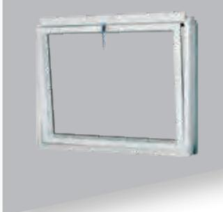
Ce modèle de fenêtre de façade est une fenêtre à ouvrant tombant vers l'intérieur (entrebâillement max. 12cm). La poignée au milieu de l'ouvrant est pourvue d'une serrure à clef. Pour faciliter le nettoyage, l'ouvrant peut être basculé complètement vers l'intérieur.
