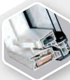
Les fenêtres les plus faciles à entretenir sont incontestablement les fenêtres en **PVC**. Les profilés extrudés à renforts métalliques, n'absorbent pas l'humidité, sont durables et sont résistants à la corrosion. Ces fenêtres sont destinées aux pièces d'eau avec un taux d'humidité constant et élevé. Les **fenêtres en PVC** sont classées dans la plus haute classe A, selon la norme NBN EN 12608, une norme de référence pour la fabrication de fenêtres en PVC.
