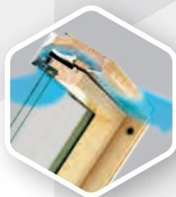
Entrée d'air réglable avec grille de ventilation, installée en partie haute dans le cadre dormant de la fenêtre. Ce système de ventilation offre en fonction de la largeur de la fenêtre un débit jusque 24,7 m<sup>3</sup>/h (à 2 Pa). Pour les locaux où une ventilation normale est exigée.
