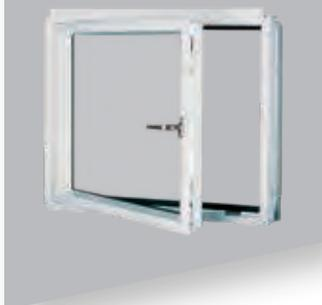
Ce modèle de fenêtre de façade fonctionne comme une fenêtre oscillo-battante traditionnelle. Le vantail s'ouvre de façon battante (à la française) ou de façon tombante. La poignée à mi-hauteur de l'ouvrant est pourvue d'une serrure à clef. Au choix, la fenêtre peut s'ouvrir par la droite (BDR) ou par la gauche (BDL, comme sur l'image).
