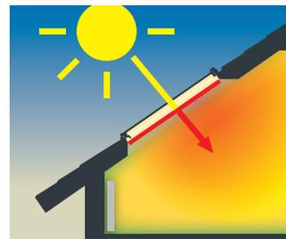
Les rayons solaires passent facilement le vitrage et sont la raison d'un échauffement excessif de la pièce.
