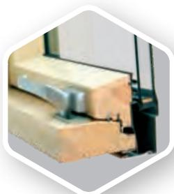
Les fenêtres en **bois** naturel sont d'une qualité extraordinaire. La menuiserie en pin est composée par des lattes, collées ensemble par assemblage à micro-denture. La menuiserie est imprégnée sous-vide et est pourvue de 2 couches de vernis incolore.
