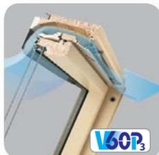
Entrée d'air réglable avec clapet de ventilation, installée en partie haute dans le cadre dormant de la fenêtre. Pour les locaux où une ventilation à grand débit est exigée. Le dispositif de ventilation V60P<sub>3</sub> est en outre auto-réglable (classe P3) et assure continuellement mais de manière contrôlée l'entrée d'air frais.
