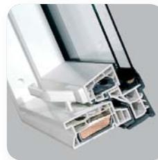
Les fenêtres les plus faciles à entretenir sont incontestablement les fenêtres en **PVC**. Les profilés extrudés à renforts métalliques, n'absorbent pas l'humidité, sont durables et sont résistants à la corrosion. Ces fenêtres sont destinées aux pièces d'eau avec un taux d'humidité constant et élevé.
