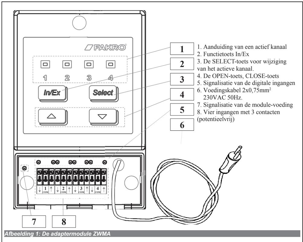
Afbeelding 1: De adaptermodule ZWMA
